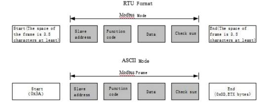
Fig. 10-2 Modbus protocol format
